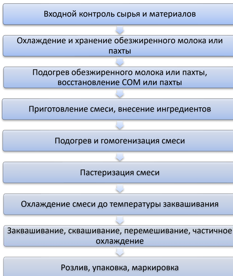
Рисунок 1 – Схема технологического процесса Источник данных: собственная разработка.
